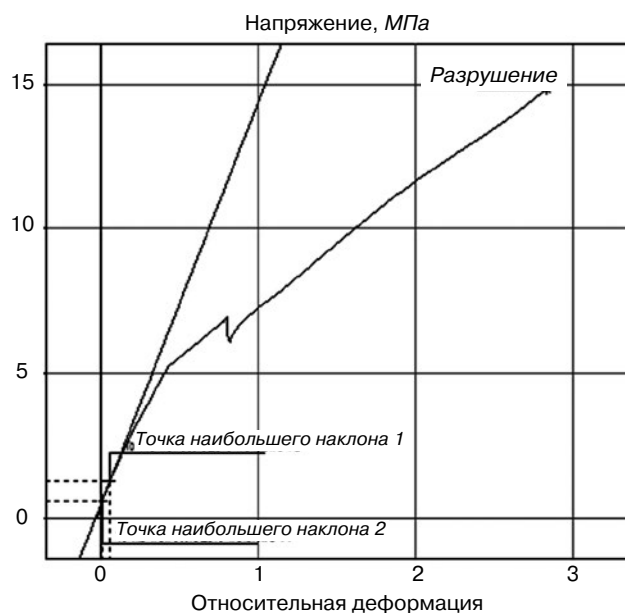
Кривая растяжения образца с добавлением ДОФ
