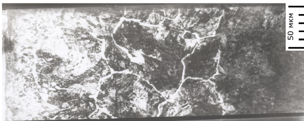
Рис. 2. Микроструктура цементованного слоя модельного сплава на основе железа, содержащего 1 % Cr, подвергнутого цементации [4]
