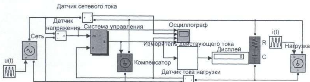
Р и с. 4. Модель компенсирующей системы в программе Simulink
