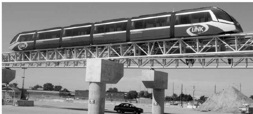
Рис. 6. Общий вид монорельсовой дороги с канатной тягой
