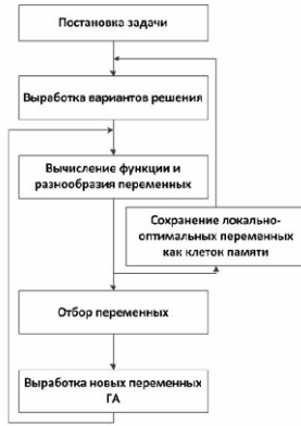
Рис. 1. Иммунный алгоритм параллельного поиска
