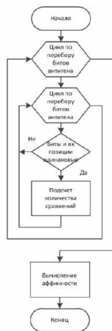
Рис.4. Блок-схема модуля Find Affinity
