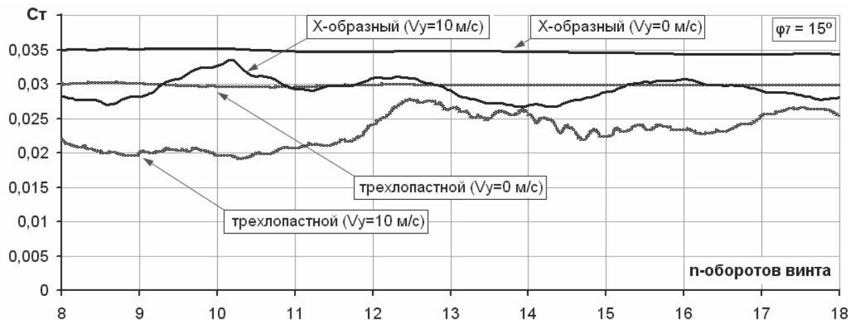
Рис. 4. Расчетные зависимости коэффициента тяги РВ на режимах висения ( \phi_{7PB} = 15^\circ ) и режиме вертикального снижения ( \alpha_H = 90^\circ ; V_y = 10 м/с; \phi_{7PB} = 15^\circ ) от числа оборотов винта n
