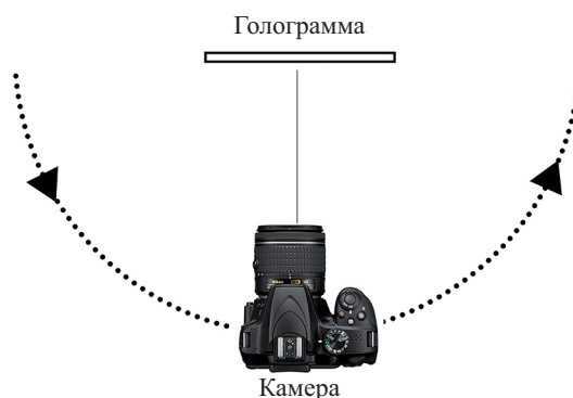
Рис. 4. Схема установки для съемки изображения, зарегистрированного на объемной отражательной голограмме
