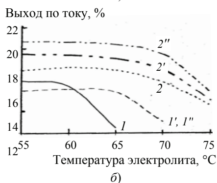
Рис. 6. Изменение выхода по току в зависимости от плотности реверсивного тока при 55^{\circ}\text{C} (а) и температуры при плотности реверсивного тока 100 \text{ А/дм}^2 (б) в тех же электролитах
