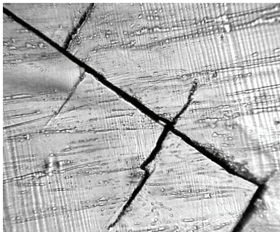
Рис. 3. Дендритная трещина в аустенитной фазе монокристалла \text{Ni}_2\text{MnGa} ( \times 100 )
