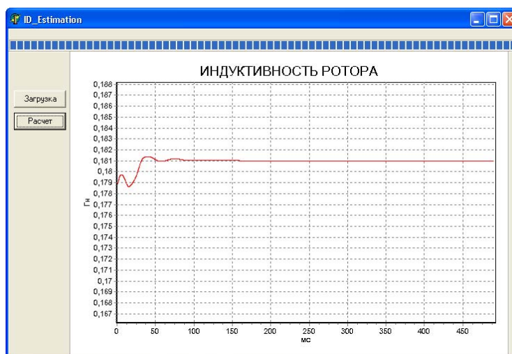
Рис.2. Процесс определения индуктивности ротора двигателя 4AX90L4Y3
