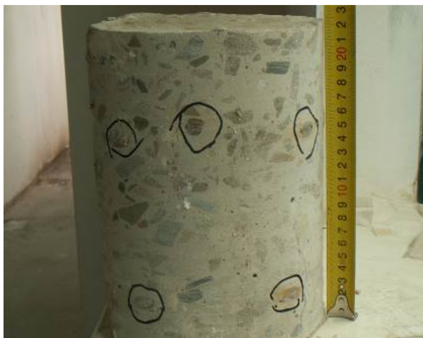
Рис. 1. Керн из плиты перекрытия одного из обследованных зданий
