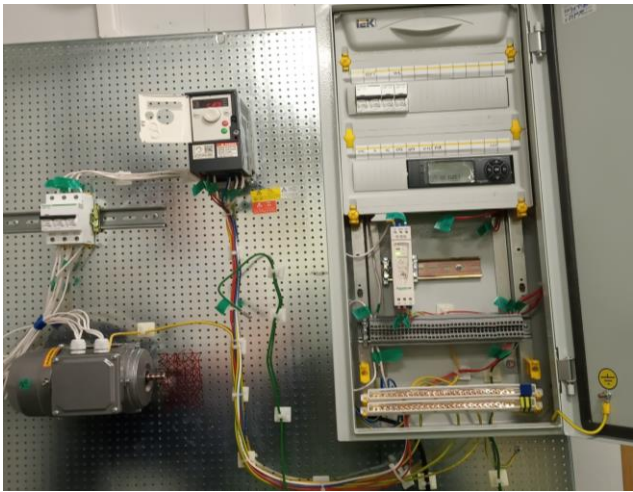
Рис. 3. Внешний вид стенда на этапе сборки
