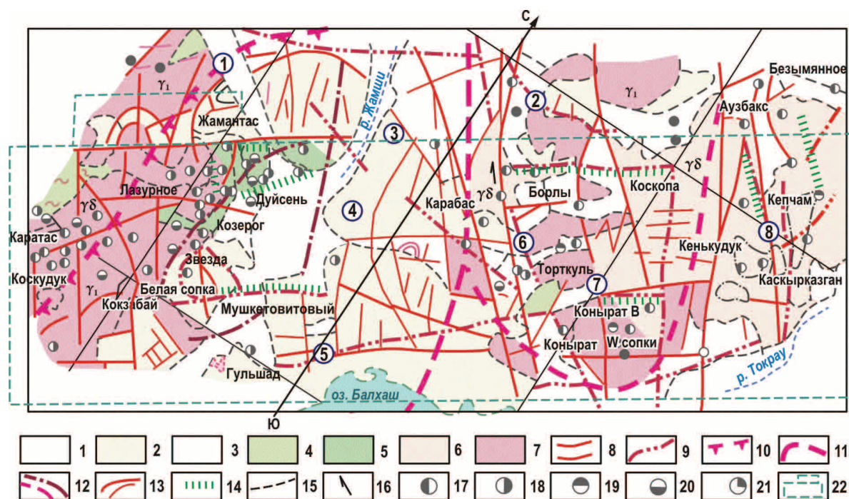
Рис. 3. Генерализованная схема геологического строения Каскырказган-Каратасской рудной зоны (составил С.А. Акылбеков с использованием [2–4, 6]). 1 – неоген-четвертичные отложения; 2 – субщелочные вулканиты кислого и среднего состава пермского возраста; 3 – вулканогенные (кислые и основные) и осадочные (карбонатные и терригенные) образования девон-карбона; 4 – регионально-метаморфизованные породы рифея; 5 – осадочные преимущественно терригенные отложения венд-кембрий-силура; 6–7 – интрузивные образования: 6 – гранодиориты, 7 – граниты; 8–14 – тектонические нарушения: 8–12 – крупные: 8 – представленные на геологических картах, 9 – по данным гравитразведки преимущественно регионального развития: 10–12 – по данным магнитной съемки: 10 – разделяющие крупные тектонические блоки (структуры), 11 – первого порядка, 12 – более высоких порядков; 13 – относительно непротяженные, малоамплитудные, в т.ч. полуконцентрические сбросо-сдвигового характера по геолого-геофизическим данным; 14 – по зоне градиентов A_g , картирующие размещение месторождений и рудопроявлений; 15 – геологические границы; 16 – сдвиги; 17–21 – месторождения и рудопроявления: 17 – медно-порфировые, 18 – медно-полиметаллические, 19 – редких металлов, 20 – железа, 21 – золота; 22 – контур основных результатов геолого-геофизических работ (рис. 4). Цифры в кружочках – долгоживущие разрывные нарушения: 1 – Кызылкемирский; 2 – Бектаутинский; 3 – Сарыкум-Бектаутинский; 4 – Каратас-Кепчамский; 5 – Гульшад-Коныратский; 6 – Конырат-Западно-Берлинский; 7 – Коныратский; 8 – Каскырказган-Кепчамский
