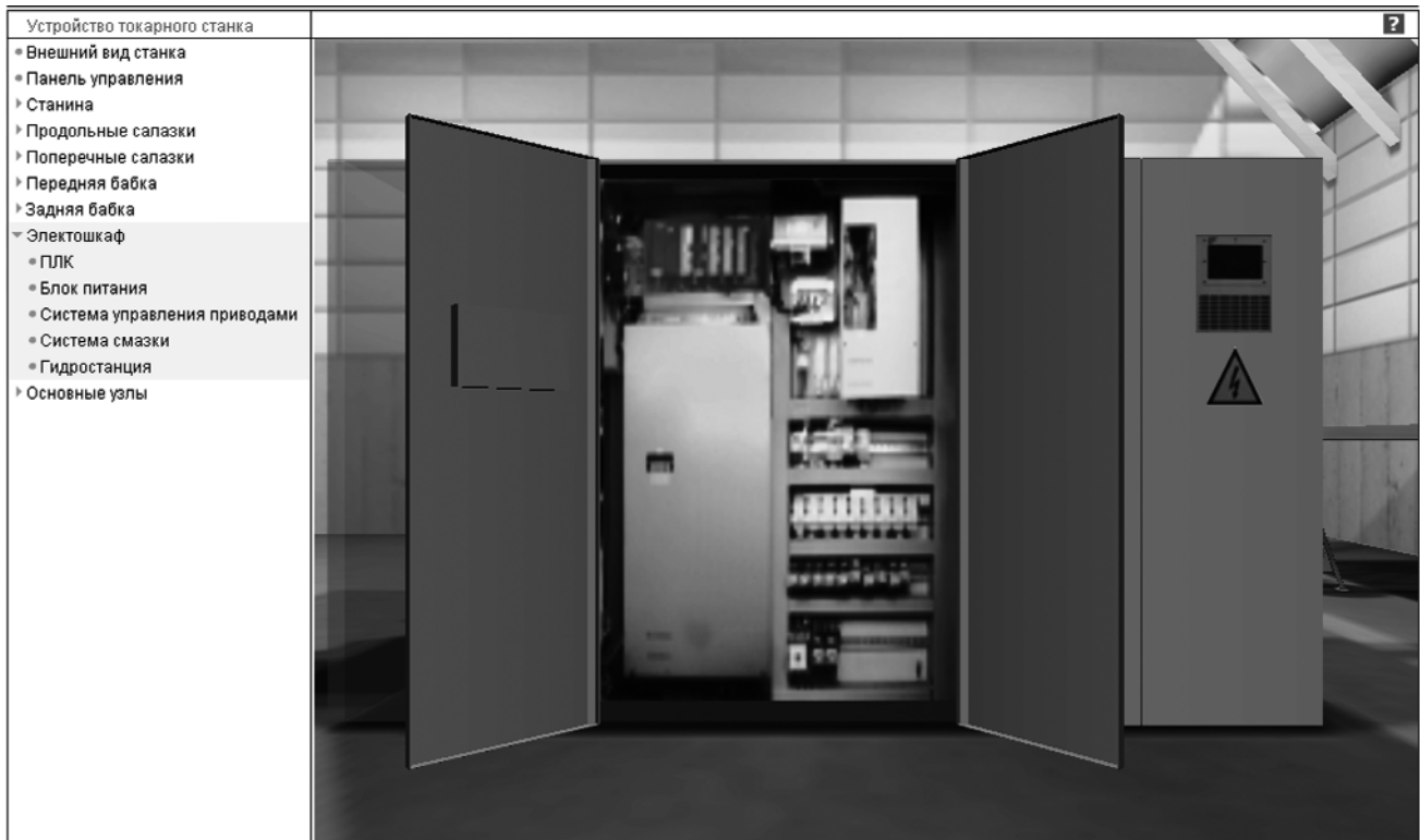
Рис. 5. Компьютерный эмулятор токарного станка с ЧПУ. Открытая секция электрощафа с блоком питания
