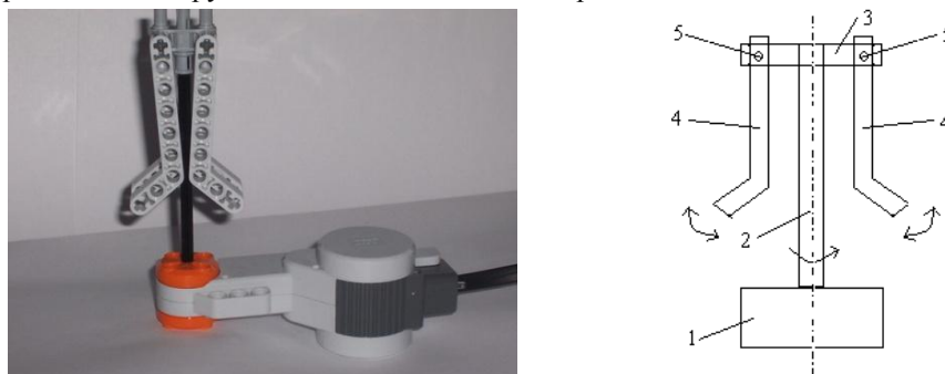
Рис. 6. Экспонат «Центробежная сила»: фотография (слева) и схема (справа)
