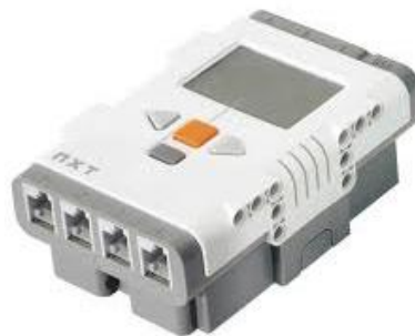
Рис. 8. Контроллер NXT Intelligent Brick
