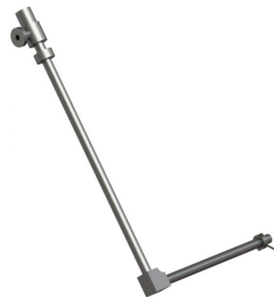
Рис.3. Твердотельная модель углового дросселя и участка трубопровода после него, построенная в SolidWorks Flow Simulation
