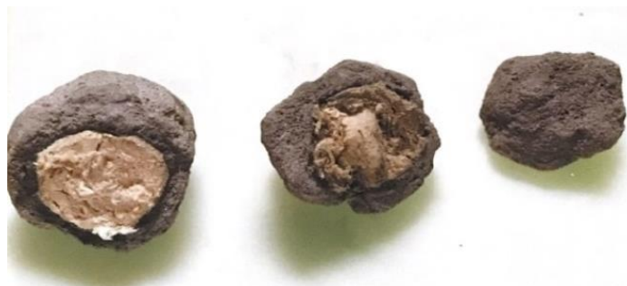
Рисунок 1. Безобжиговый гравий, модифицированный комплексными добавками на основе техногенных пуццолан и водоредуцирующего суперпластификатора (разработано авторами)
