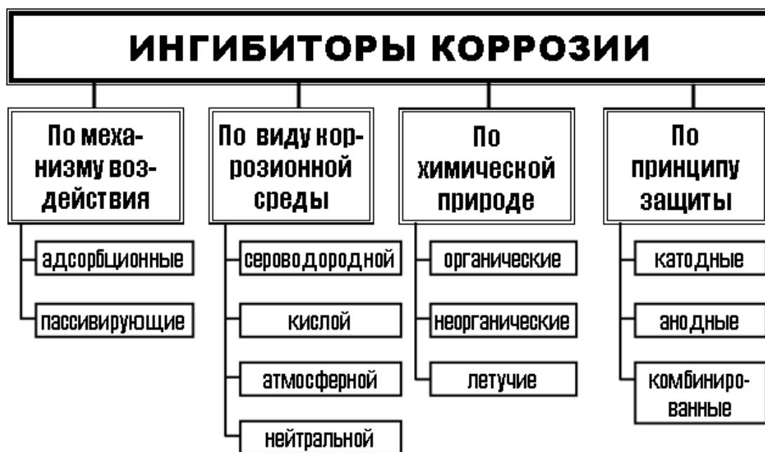
Рисунок 2 – Классификация основных видов ингибиторов коррозии строительных металлоконструкций
