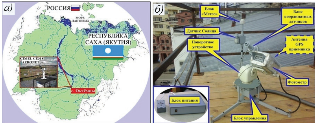
Рис. 2 (а, б). Вид и расположение солнечного фотометра марки CIMEL CE-318 на полигоне «ШАЛ» ИКФИА (а) и SP-9 на крыше здания института в г. Якутске (б)
