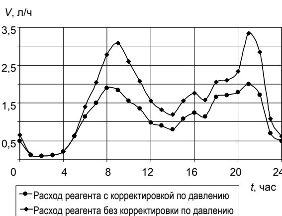
Рис. 7. Суточный график дозирования реагента (ЦТП жилого микрорайона)
