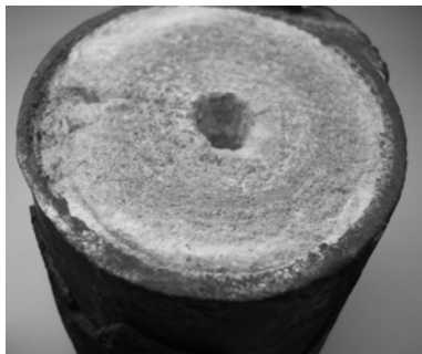
Рис. 1. Отложения солей в котловой трубе Fig. 1. The deposits of salts in the boiler tube
