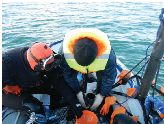
Рис. 4. Извлечение накопленных осадков из пробоотборной трубки на борту
