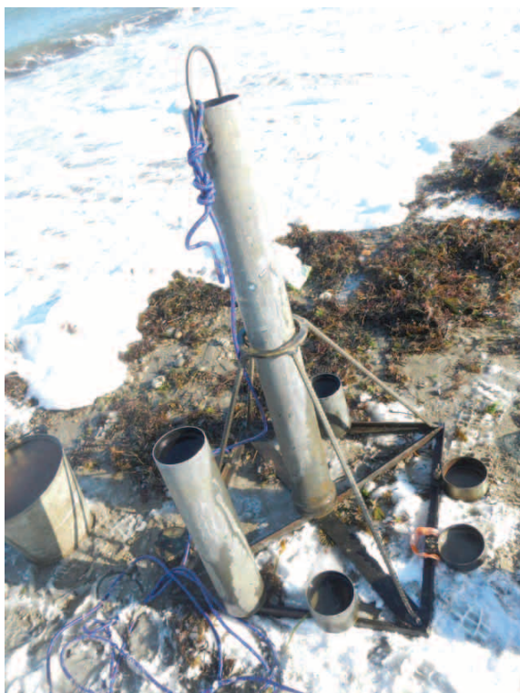
Рис. 3. Станция для пробоотбора перемещаемых осадков из придонного потока
