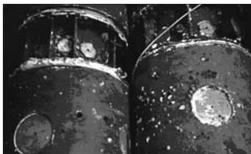
Коррозионные разрушения элементов крупногабаритных изделий при испытании на глубине в морской среде, бухта Рында
