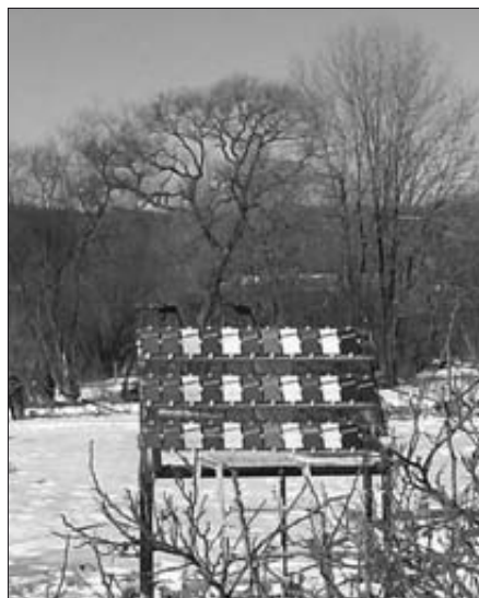
Стенд испытаний порошковых композиционных покрытий на атмосферную коррозию
